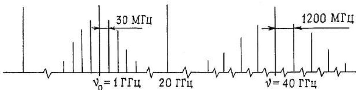
Рис. 13. Генерация на ГМК эквидистантных сеток частот в полосе 10 МГц – 40 ГГц. Показаны сетки частот в области фундаментальной частоты 1 ГГц и гармоники – с номером 40 ГГц
