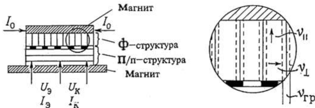
Рис. 11. Многокомпонентная феррит-полупроводниковая структура – гетеро-магнитный радиокомпонент (ГМК)
