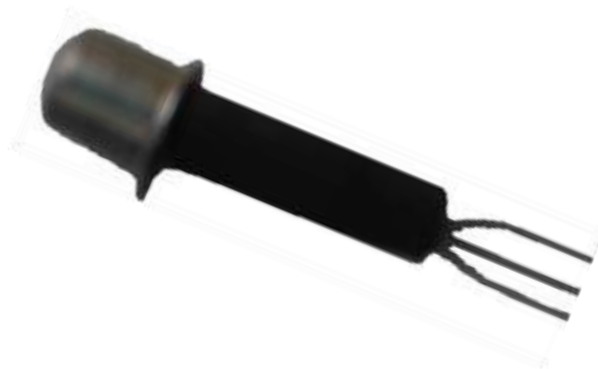
Рис. 1. Аналоговый датчик температуры
