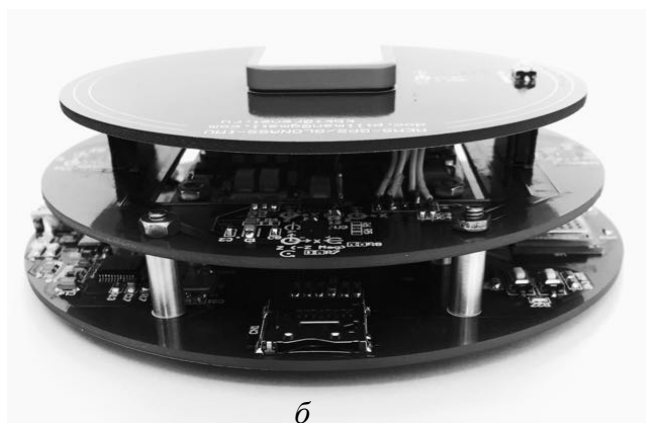
Рис. 1. Магнитоинерциальный модуль: а – общий вид; б – без кожуха и основания
