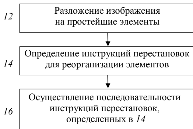
Рис. 5. Блок-схема метода перестановки субслов для использования в параллельной обработке (обозначения даны в соответствии с [11])
