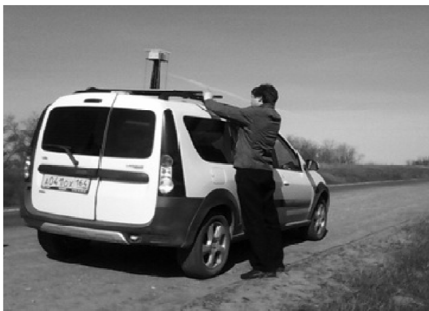
Рис. 1. МИМ-2 смонтирован на немагнитной стойке, установленной на автомобиле LADA Largus
