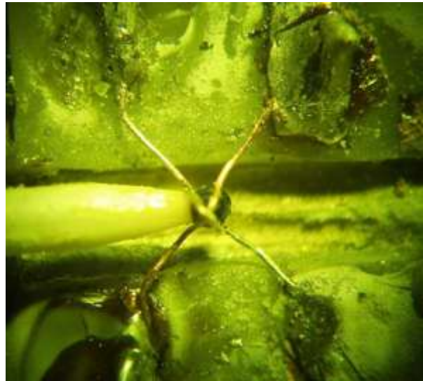
Рис. 6. Элемент связи в виде скрещенных витков с ЖИГ-сферой КГ15
